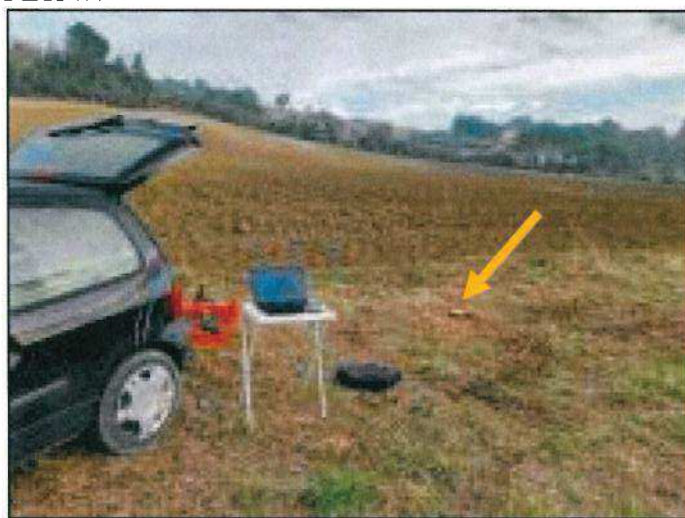
Figura 13 – Postazione tromografo per prova sismica HVSR (da report d'indagine)
