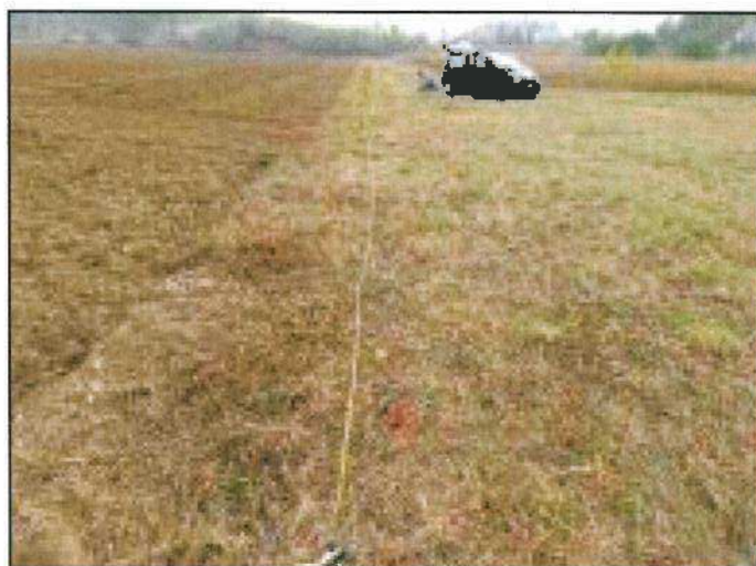
Figura 11 – Stendimento prova sismica MASW ( da report d'indagine)
