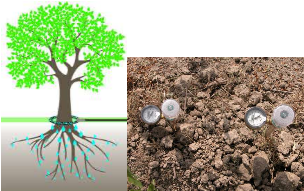
Schema per l'irrigazione di nuove alberature e igrometri per la regolazione dell'impianto
