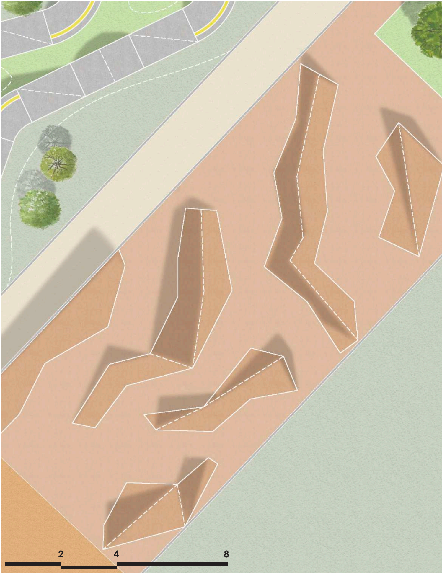
Pavimentazione in cemento drenante sagomato, pedane, rampe ed altri elementi in legno e metallo
